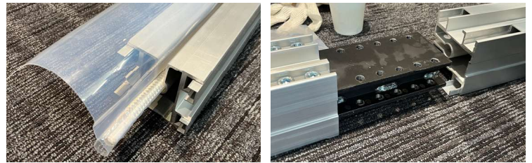
アルミフレームとETFE膜定着部のモックアップ
