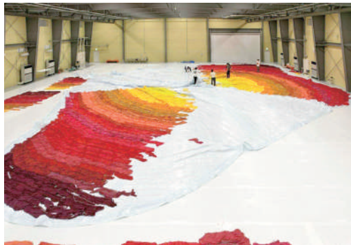
ピザのピースのように反付けされた膜に対してピースを取り付けていく
