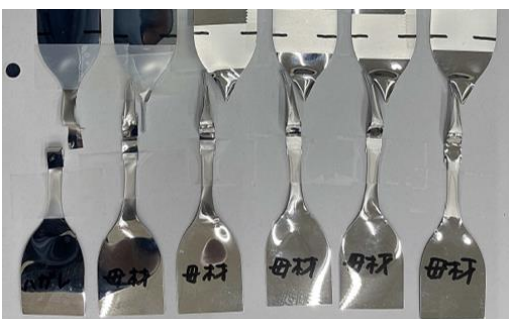
膜材の引張試験後サンプル
