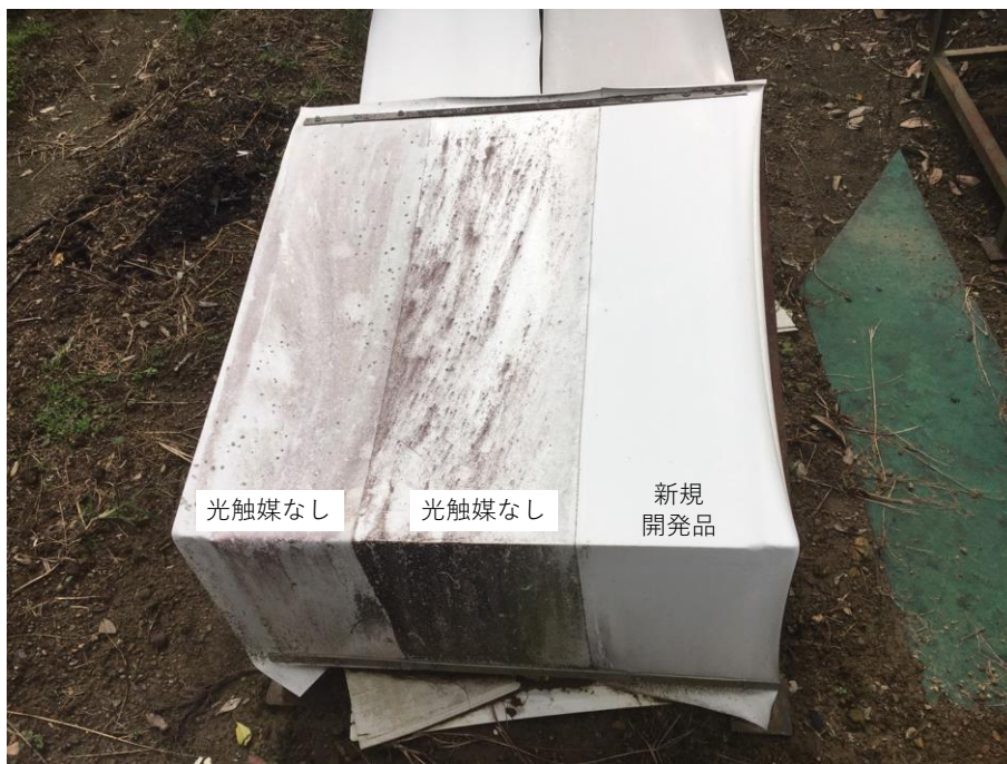
図10 開発品の屋外暴露試験の写真
