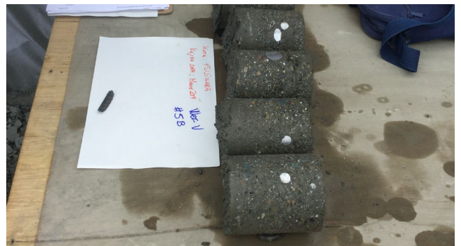
コア抜き 充填状況確認
