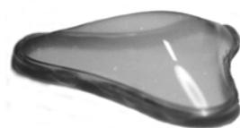
図3 石鹼膜模型空気膜形態
