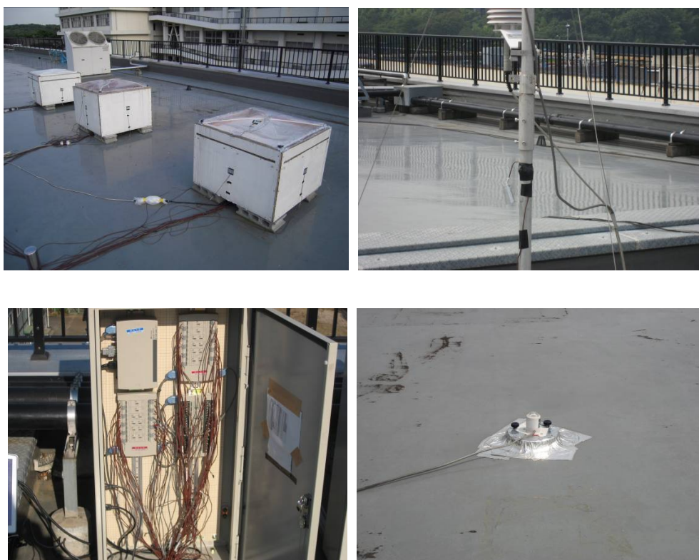
図 3-2-1 測定機器 [小型模型(左上)、CADAC(左下)、外気温(右上)、日射計(右下)]
