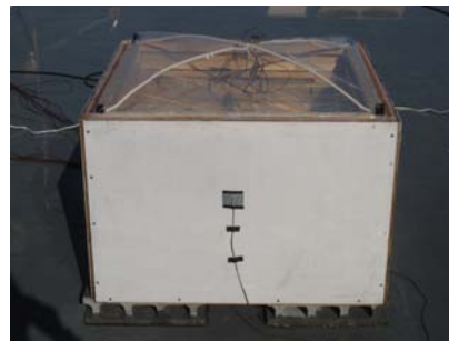
図 3-1-4 ETFE 二重膜模型
