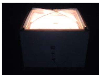
図 3-1-11 ETFE 二重膜模型
