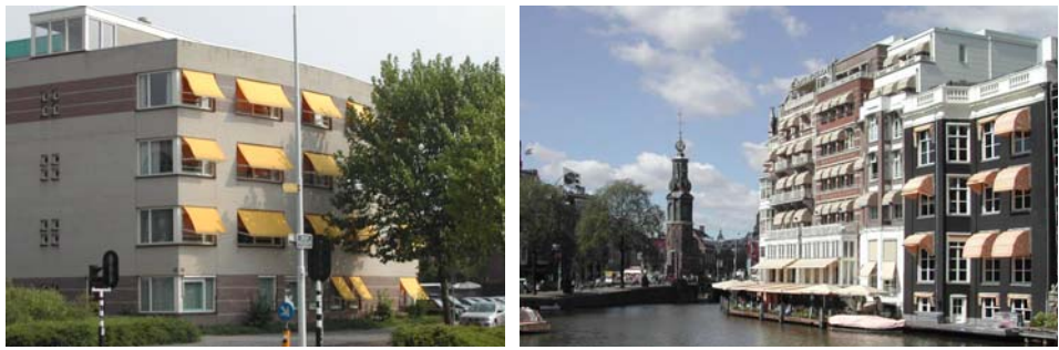
図 1-1-4 膜材料を用いた日射遮蔽の例(オランダ)
