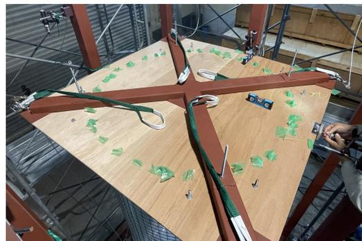
写真4 C形鋼による上板の補剛
