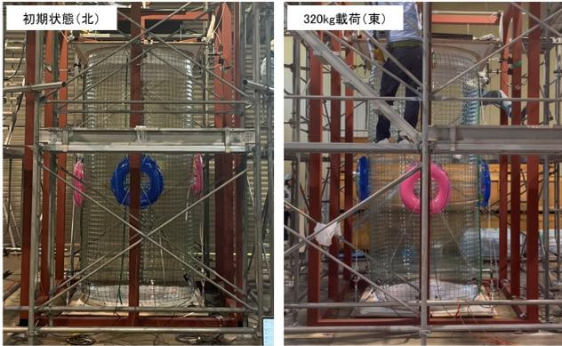
写真8 初期状態（北）および最大荷重時（東）
