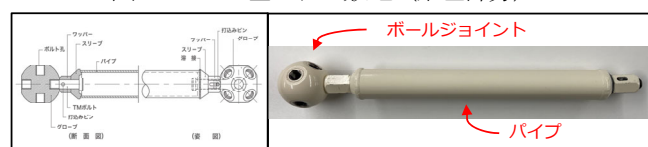
図5：システムトラスの部材
