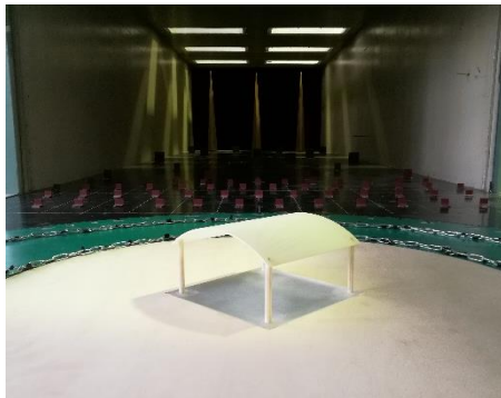
写真1 風洞実験の様子
