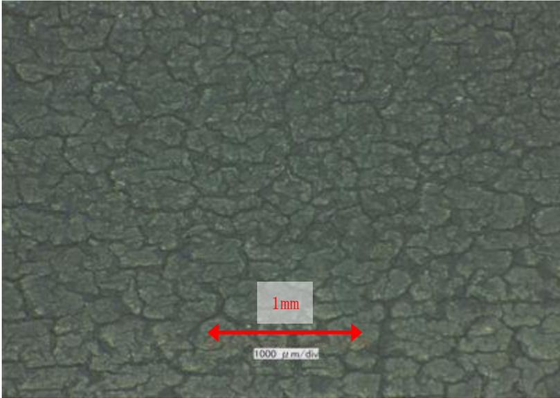
写真 5-6-6 No⑧カバーゴム 外部側表面
