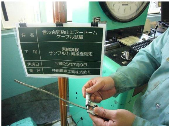
写真 4-31 素線径の計測
