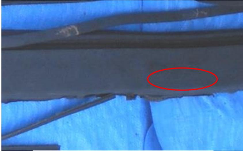
写真 5-4-3 ケーブル定着部 ②⑥⑧カバーゴムサンプリング位置
