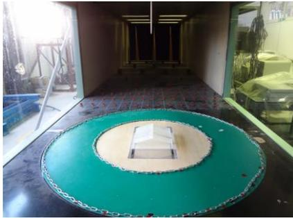
図2 風洞内に設置された実験模型
