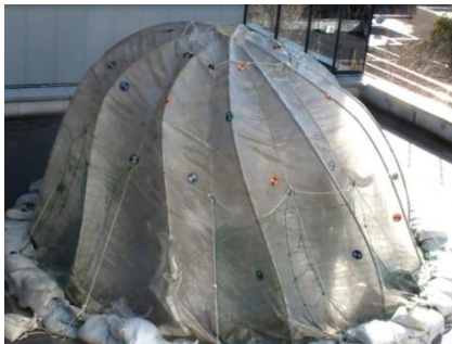
図18(a) 無補強の骨組の座屈時の外観 (気圧差約-50Pa)
