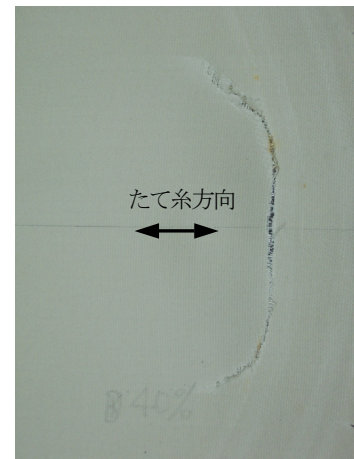
図 4.3 載荷圧力 160kPa の破断状況
