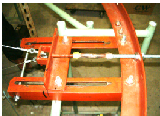
写真6 張力導入用ターンバックル
