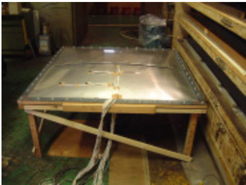
写真 1 ウレタン樹脂充填後の状況 (Out-100)
