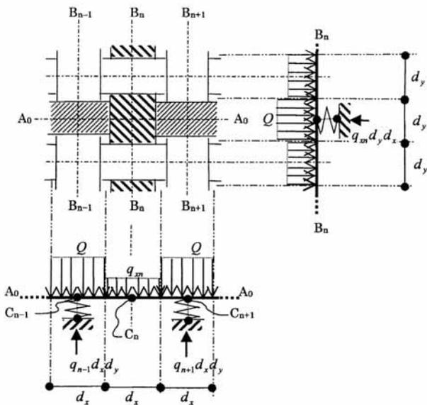
図3 膜要素交差部での外部圧力と交差部接触面相互作用力のモデル化
