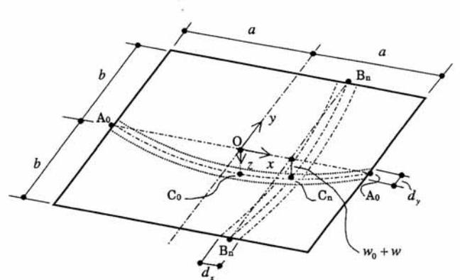
図2 一方向の主膜要素  $A_0A_0$  と直交膜要素  $B_nB_n$  へのモデル化
