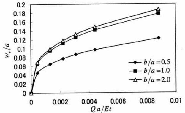
図 12 3 ケースのアスペクト比について計算した圧力—中央変位関係
