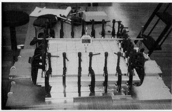
図7 空気圧による正方形膜の中央変位を測定する実験
