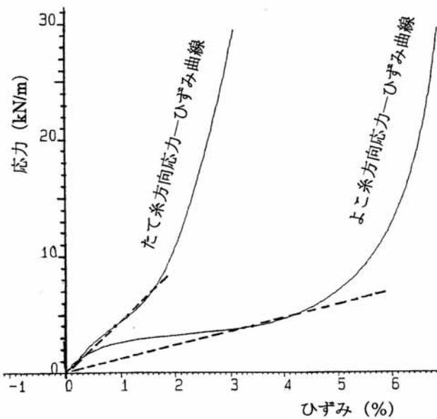
図8 供試膜の測定1軸応力-ひずみ曲線
