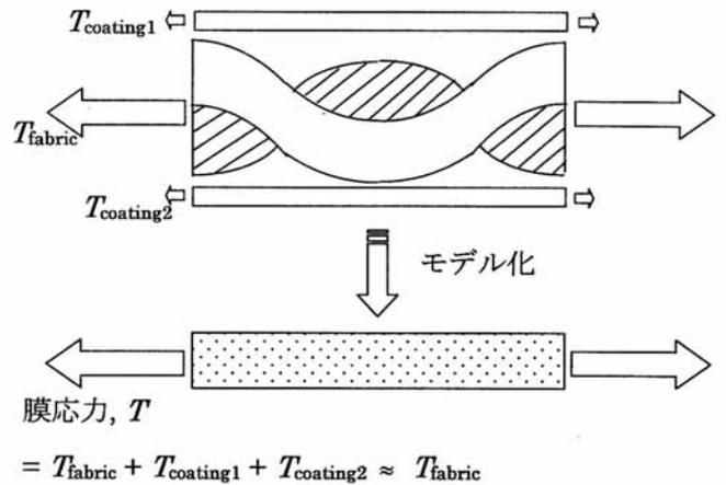
図1 コーティング加工平織物の膜応力の定義
