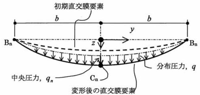
図5 直交膜要素  $B_nB_n$  の解析モデル
