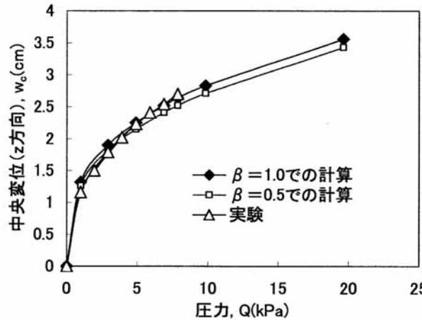
図9 計算と実験による中央変位と圧力の関係
