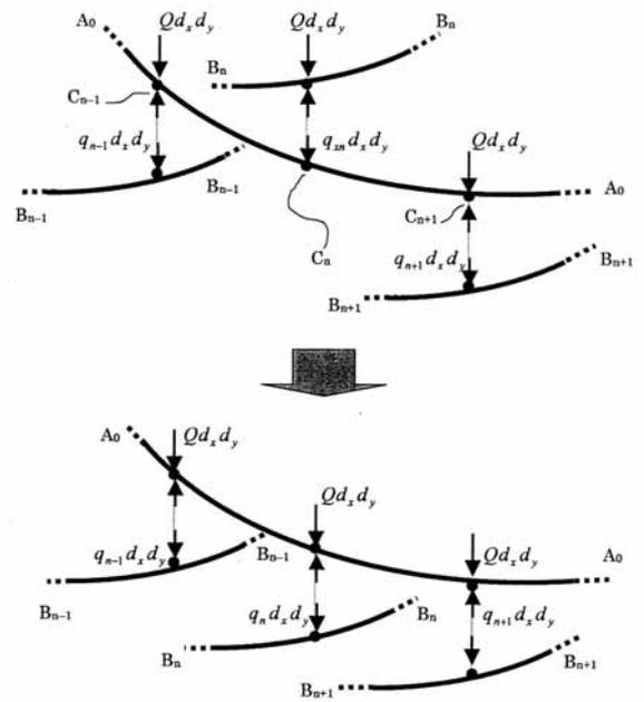
図4 主膜要素と直交膜要素で構成されたコーティング平織物膜モデル
