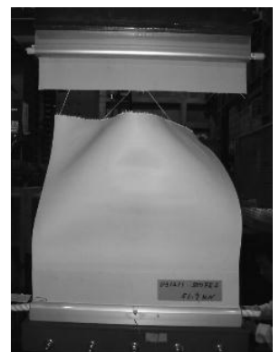
図 15 試験体の破断形状 (ヨコ糸方向)
