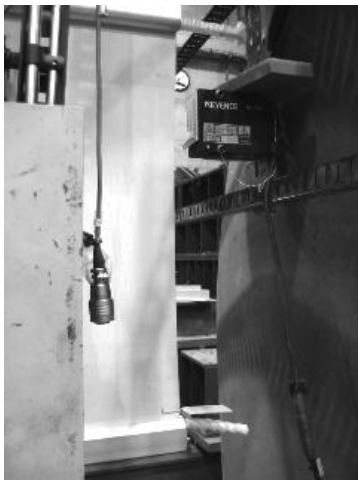
図4 レーザー変位計測の様子
