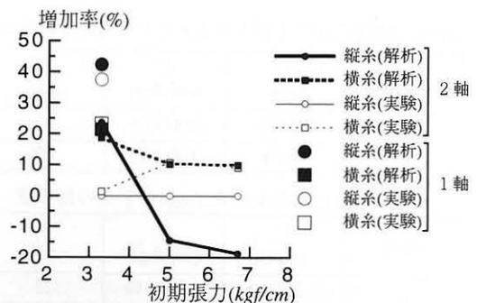
図23. クリープひずみの増加率
