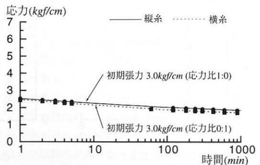
図8. 1軸応力緩和試験の結果
