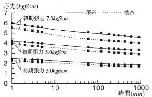
図7. 2軸応力緩和試験の結果
