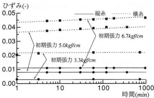
図5. 2軸クリープ試験の結果
