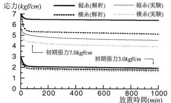
図13. 表5の値を用いた2軸応力緩和解析
