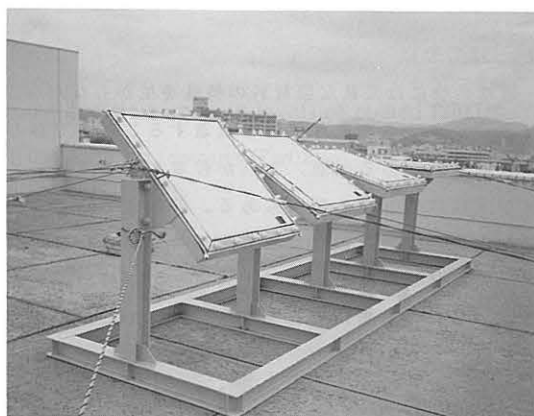
図-3 屋根面の暴露角度を変えた状態での屋外暴露試験状況：右から水平面に対して0°, 15°, 30°, 45°
