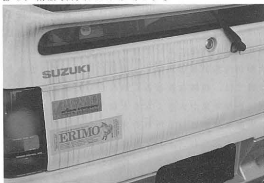
図-1 自動車側面にみられる雨筋状汚れ
