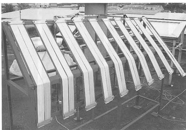
図-5 側面の暴露角度を変えた状態での屋外暴露試験状況(右から 45^{\circ} , 50^{\circ} , ..., 90^{\circ} )
