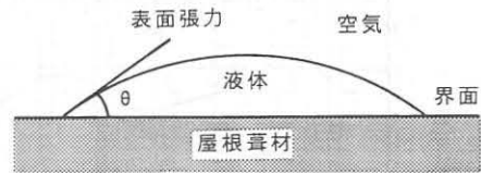
図2 接触角の定義
