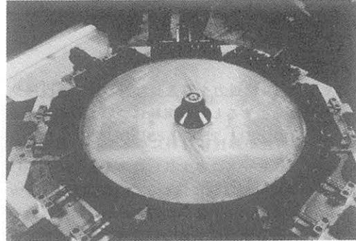
写真8. 気球の材料(直交異方性、トルク=325kgf・cm)
