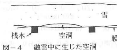
図-4 融雪中に生じた空洞
